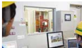
사고를 상정한 대전류를 통전하여 안전성을 검증하는 차단 시험
