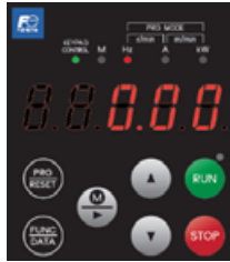
図 4.3-1 電源投入時の LED モニタ表示
