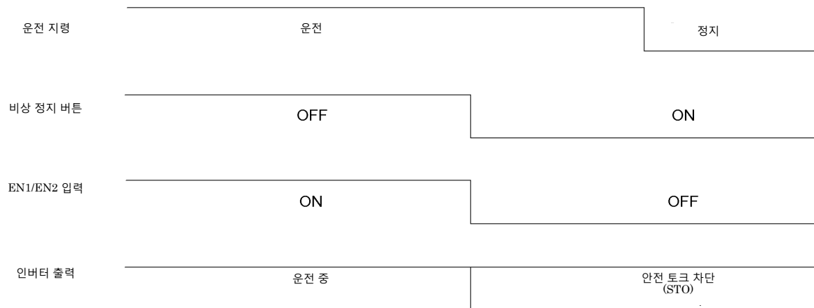
그림 9.8 비상 정지 버튼이 OFF 되어 인버터가 운전될 경우 인버터 출력 상태
