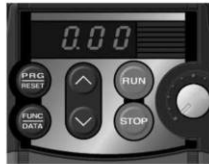
그림 4.2 전원 투입시의 LED 모니터 표시
